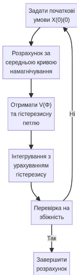
рис. 2 Блок-схема, що ілюструє алгоритм розрахунку ustalених режимів електромагнітних пристроїв з урахуванням гістерезису
